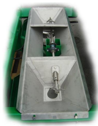
Нижняя часть бункера из нержавеющей стали. Мешалки с цепным приводом и автоматическим натяжителем для равномерной подачи удобрений
