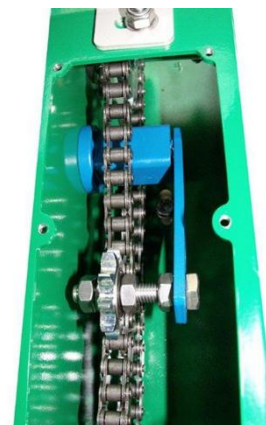
Нижняя часть бункера из нержавеющей стали. Мешалки с цепным приводом и автоматическим натяжителем для равномерной подачи удобрений
